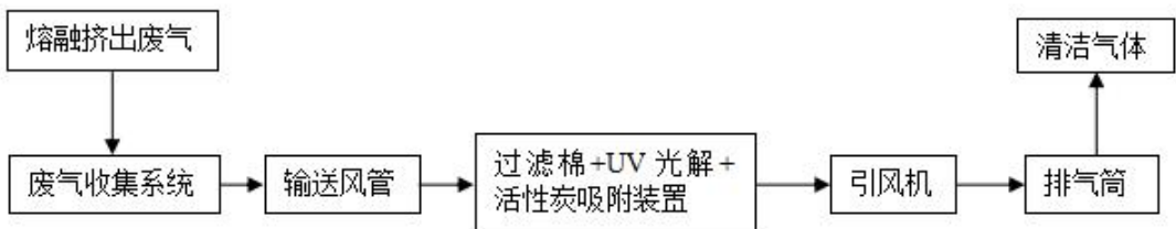
图6 熔融挤出废气处理工艺流程图
