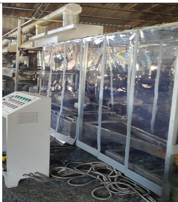
挤出机上的集气罩
