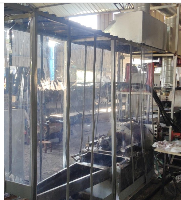
挤出机上的集气罩
