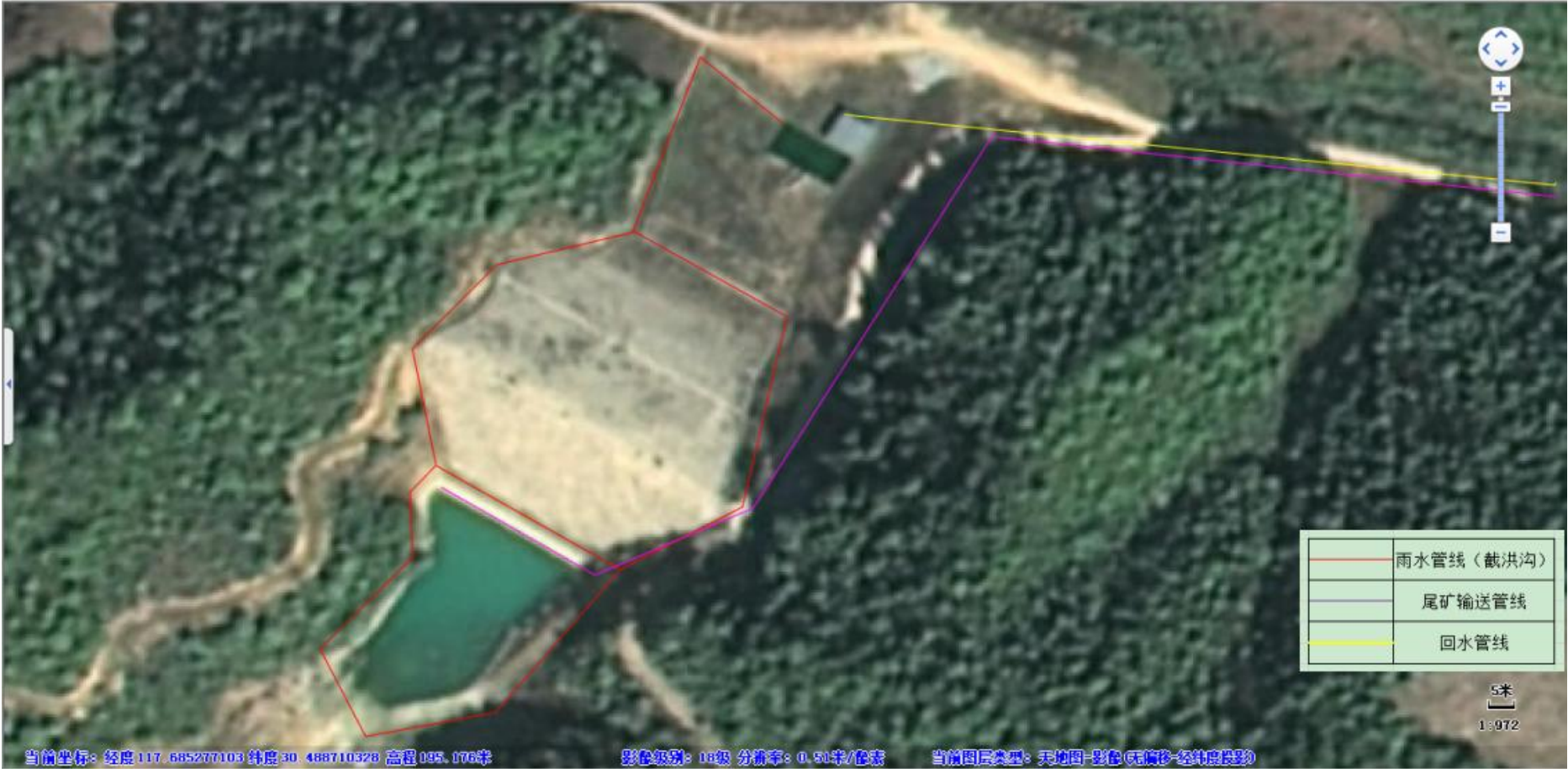
附图 1 项目雨污管网布置图
